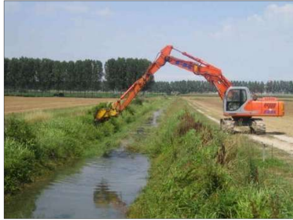
Attività di sfalcio svolta utilizzando benne sfalcianti montate su escavatore
