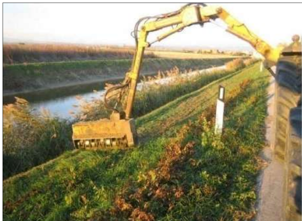
Decespugliamento di scarpate di canali e sponde argini con trinciastocchi
