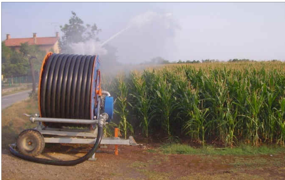
Altri esempi di sistemi irrigui: irrigazione ad aspersione con rotolone
