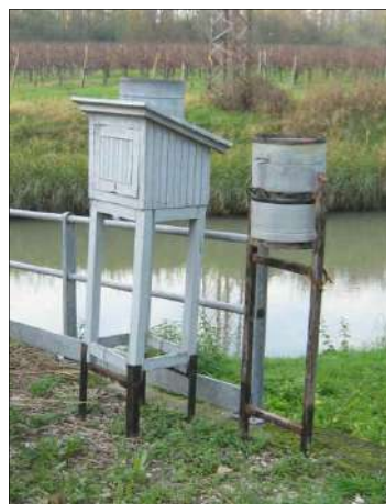
Esempi di pluviometri: a sinistra, un pluviometro automatico, a destra, un pluviometro manuale
