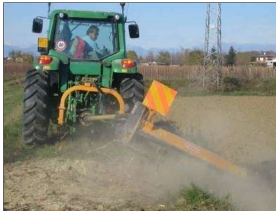
Decespugliamento di scarpate di canali e sponde argini con trinciastocchi
